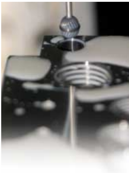
Nach getaner Arbeit: Bei Festo verrundet der Orbitool-Entgrater schonend die Kanten an der Bohrungsschnittstelle.
